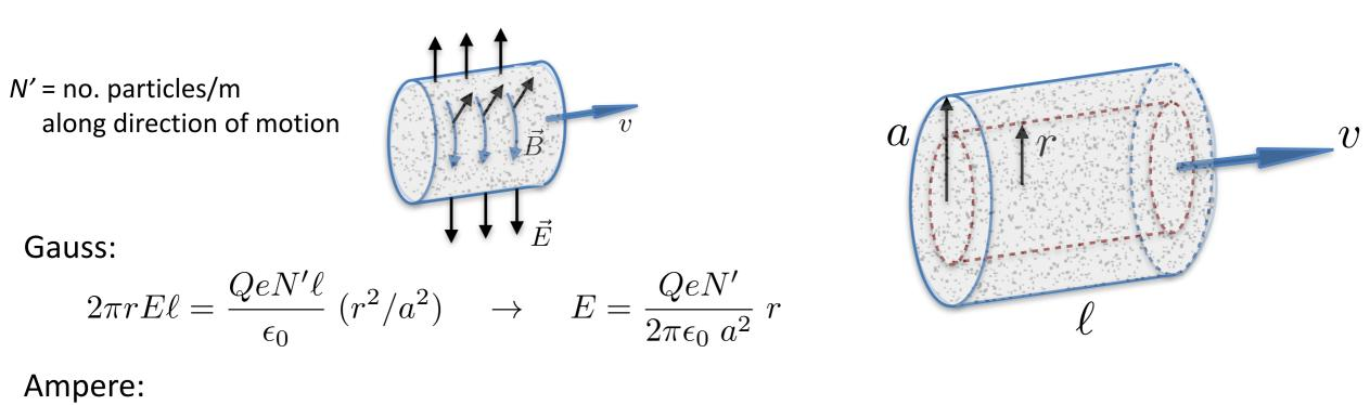
$$2\pi r B = \mu_0 \ QeN'v \ (r^2/a^2) \quad \to \quad B = \frac{\mu_0 QeN'v}{2\pi \ a^2} \ r \quad \to \quad \frac{QeN'v}{2\pi\epsilon_0 c^2 a^2} \ r$$
